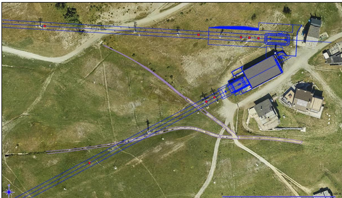
Planimetria di dettaglio con i tracciati dei canali rilevati dal topografo
